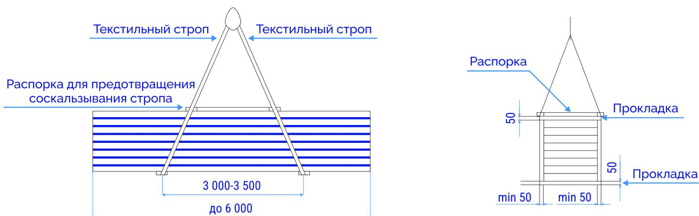
Рис. 2. Строповка транспортных пакетов длиной до 6 метров без применения траверсы
